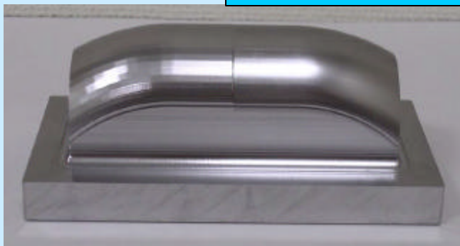
左半分がCAD/CAMの多面体形状補間 右半分がCoons曲面パッチ形状補間
