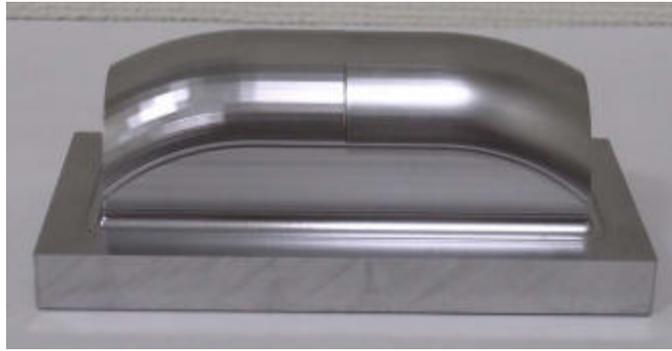
図 3.2.6 仕上げ加工の結果（右半分の領域）
